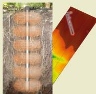
Placement optimisé des sondes capacitatives à profil AquaCheck et des capteurs Nutrisens selon la nature du sol (RFU) et les équipements pour un pilotage précis de votre irrigation et de votre nutrition
